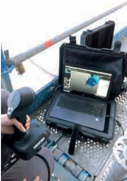
Fig. 26.- Scan 3D d'une pierre à restaurer. © Architectes associés s.a., société civile d'architectes.
