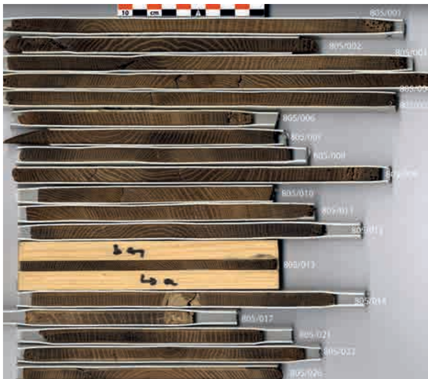
Fig. 15.- Scan de dix-huit échantillons dendrochronologiques. © Emmanuel Delye (ULg-CEA 2015).
