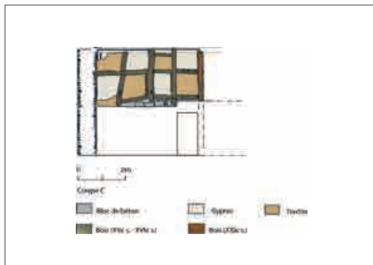
Fig. 12.- Relevé du mur est du logis (coupe C, voir plan - fig. 7). © Sara Pholien.
