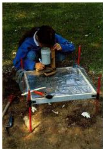
Fig. 5. Réalisation d'un plan de répartition d'ossements humains, à grandeur naturelle, à l'aide d'un dispositif composé d'une plaque de plexiglass montée sur pieds coulissants, permettant de placer une feuille de plastique transparent en position horizontale à une vingtaine de centimètres au-dessus des pièces à dessiner; un viseur mobile élimine les erreurs de parallélisme (photographie de démonstration).
